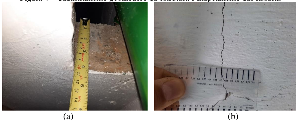
Figura 4 – Cadastramento geométrico da estrutura e mapeamento das fissuras
